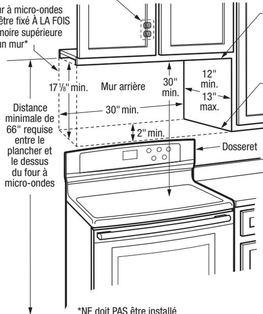
L'arête inférieure de l'armoire DOIT être à 30" minimum de la surface de cuisson
